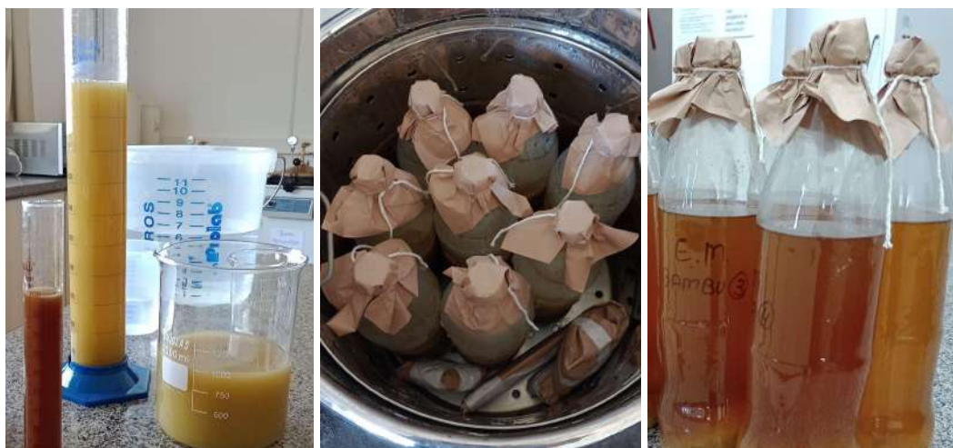
Figura 4: Preparo da solução nutritiva para a fermentação dos E.M. a: preparo das soluções; b: autoclavagem das soluções e c: soluções preparadas e autoclavadas.
