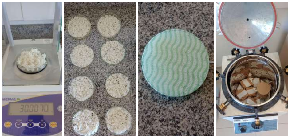
Figura 1: Preparo das iscas para a coleta dos E.M. a: pesagem do arroz; b: iscas pesadas; c: iscas protegidas e d: autoclavagem das iscas.
